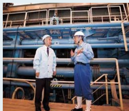
材料開発・評価に関するソリューション技術の例： 8,000トン大型引張試験機
